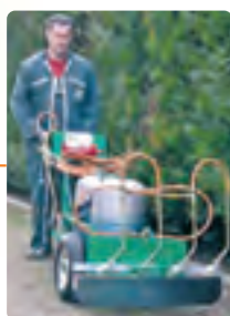
Désherbeur thermique à flamme directe, conçu pour grandes surfaces, allées, trottoirs, modèle à rampe et à 2 bouteilles, Charoiflam 800, ZEBALM
