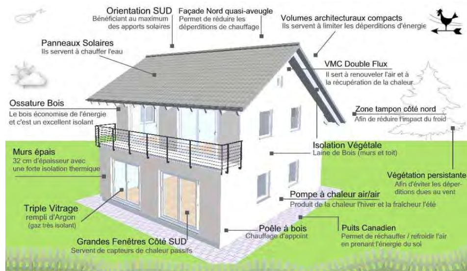
Schéma de synthèse reprenant les dispositifs d'isolation et de production d'énergie actuels, ainsi que les choix constructifs en fonction des différentes expositions
