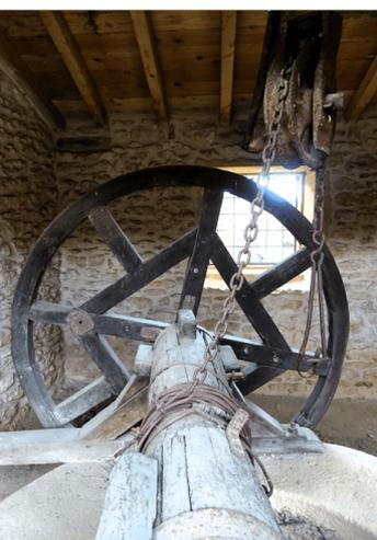
Le puits, creusé dans les roches du Jurassique étant d'une grande profondeur, un astucieux système a été mis en place pour remonter le seau rempli d'eau sans trop d'effort.
